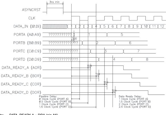
Note: DATA\_READY A = DRA (pin A6) DATA\_READY B = DRB (pin H1) DATA\_READY C = DRC (pin W5) DATA\_READY D = DRD (pin W16)
